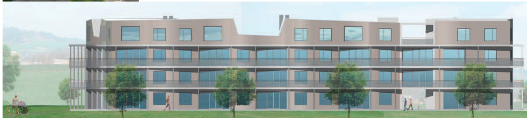
8.16a ökolog. Holz (Zug)- Beton (Druck) -Bau , mit Hybrid-PV-Dach und Erdspeicher 9 (U-Sonden: 80-120m) für ca +1-2 Grad (rechts im Bild) ca. 90% thermische Bedarfsdeckung. www.Wohnbaugenossenschaft.ch Oberfeld in Ostermundigen, autofrei. Die Sickergruben und weinigen Grünanlagen sind spielerisch und gestaltungsoffen angelegt.
