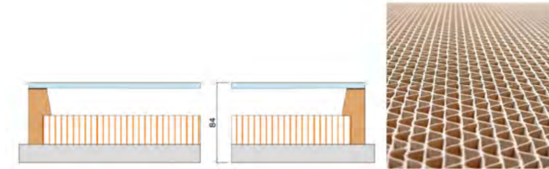
Figure 10 : Coupe de l'élément préfabriqué (à gauche), isolation en nid d'abeille (à droite) [2]
